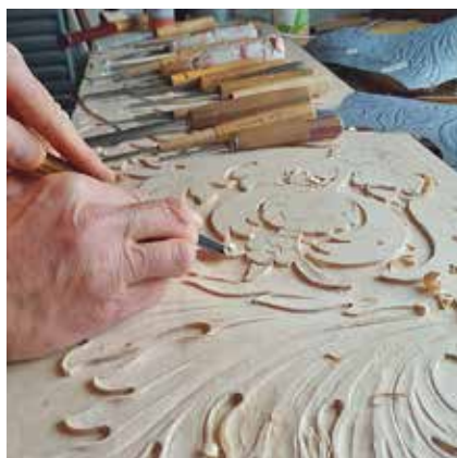
Schnitzarbeit am Relief des Prägemodells Foto: Werkstatt Arnold Holznecht
