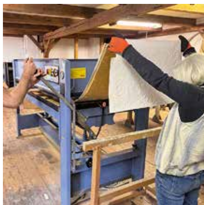
Prägung einer Tapetenbahn mit der Furnierpresse Foto: STSG, Uta Kolano
