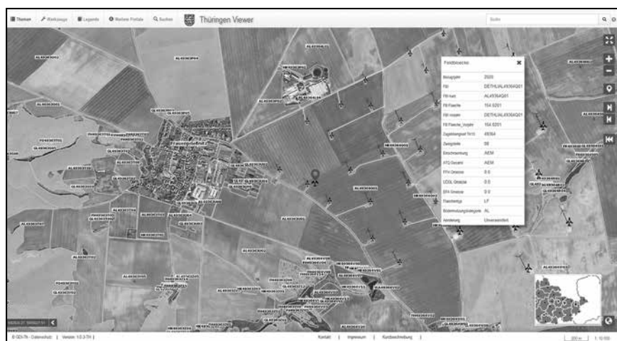
Kombinierte Darstellung verschiedener Fachdaten aus dem Bereich der offenen Geodaten (Digitales Orthophoto in Farbe, Feldblöcke aus InVeKoS und raumbedeutsame Windkraftanlagen) im Anzeigemaßstab 1 : 10.000. Im rechten Bereich ist die Anzeige von Objektinformationen für einen ausgewählten Feldblock (Lage in den Gemeinden Frauenprießnitz und Schkölen im Saale-Holzland-Kreis) zu sehen. Grafik: GDI-Th
