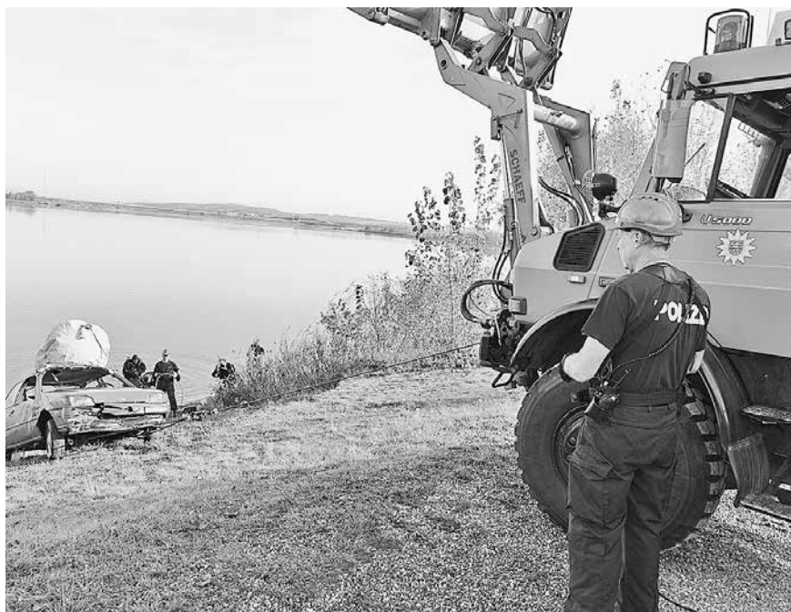
Per Hebeballon und Seilwinde des Unimogs kann die Technische Einsatzinheit der Bereitschaftspolizei auch dieses in einem See versenkte Fahrzeugwrack wieder ans Tageslicht befördern
