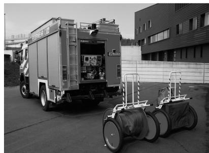
Neben einer Feuerlöschkreiselpumpe und einer Druckluftschauanlange führt das Fahrzeug auch eine 50-kg-ABC-Pulver-Haspel (rechts) mit. Das Allradfahrzeug stellt sicher auch im Winter ein schnelles und sicheres Vorankommen.
